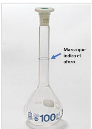
**Figura I.7:** Matraz aforado o volumétrico de 100 mL
