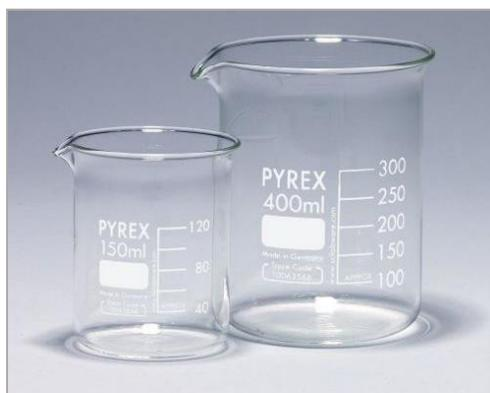
**Figura I.23:** Vasos de precipitado. La fotografía muestra dos vasos de precipitado, de 150 mL, a la izquierda y 400 mL, a la derecha.
