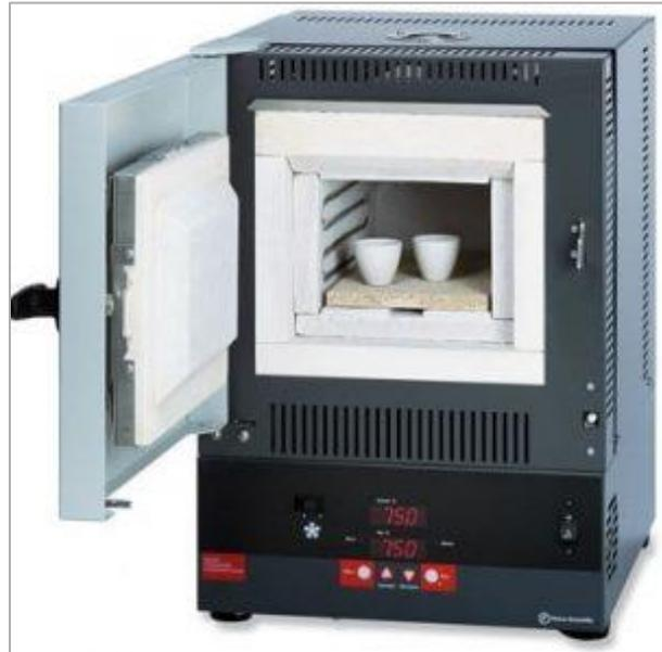
**Figura I.19:** Mufla eléctrica. Se observan dos crisoles de porcelana conteniendo la muestra.
