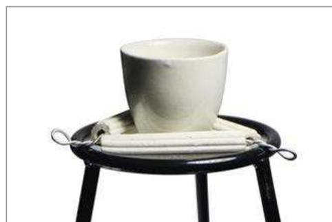
**Figura I.28:** Trípode y triángulo de pipas, sobre el cual se apoya una cápsula para calentamiento directo.
