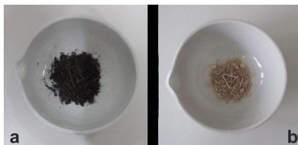
**Figura II.3:** Calcinación. a- fotografía de una muestra seca de suelo contenida en una cápsula de porcelana antes de la calcinación b- fotografía de la muestra luego de calcinada.
