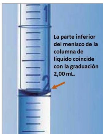
**Figura I.14:** Enrase en una pipeta de 5 mL graduada. El nivel de líquido quedó en 2,00 mL (cantidad de líquido que fue expulsado), ya que la parte inferior del menisco coincide con la graduación. Dicha nivelación debe ser leída a la altura de los ojos del manipulador. Otra observación de interés en este ejemplo de pipeta es que la división es cada 0,05 mL, mientras que otras pipetas tienen divisiones cada 0,1 mL.
