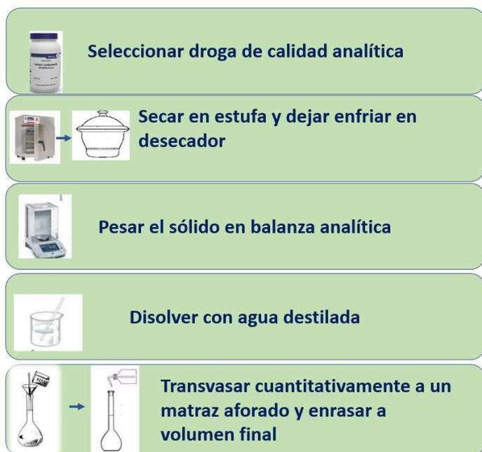
**Figura IV.16:** Pasos para la preparación de soluciones a partir de patrón primario sólido. La elección de drogas de calidad pro-análisis, el secado del sólido, la elección de instrumentos de mayor precisión y los cuidados en la manipulación, diferencian esta preparación de la que se requiere para soluciones de uso auxiliar.
