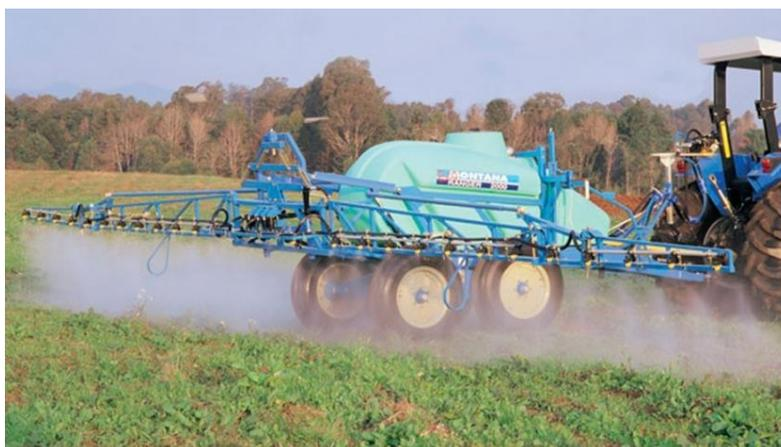
**Figura VI.11:** Aplicación de productos fitosanitarios a campo a través de la técnica de aspersión o pulverización
