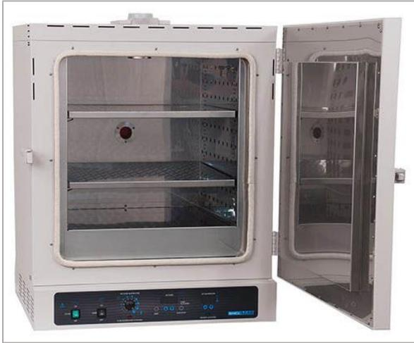
**Figura I.18:** Estufa de secado de laboratorio.
