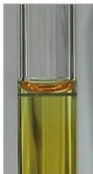
**Figura I.8:** Enrase del nivel de líquido en el matraz aforado. El líquido forma un menisco cóncavo hacia arriba. El fondo del menisco debe coincidir con la marca del aforo, leída desde la altura de éste, para no cometer error de paralaje.
