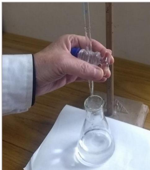
**Figura I.12:** Manipulación de la bureta. El robinete de la bureta se toma con la mano izquierda para una persona diestra. Se sujeta con los dedos pulgar, hacia el operador, y el índice, más alejado del operador. Esta técnica permite que el robinete se mantenga dentro del cilindro del cuerpo de la bureta durante la operación, evitando pérdidas de líquido que ocasionarían error.
