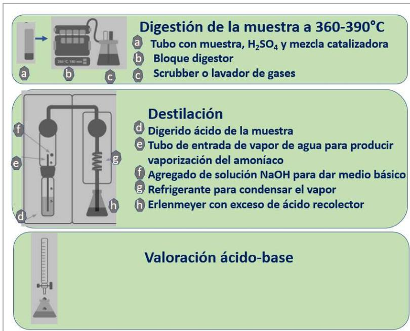
**Figura IV.18:** Esquema general de las etapas de Kjeldahl. Se representa un bloque digestor que está conectado a un lavador de gases, el cual recolecta y contrarresta los efectos de los gases tóxicos generados; el equipo destilador automatizado y por último el equipo para la valoración ácido-base.
