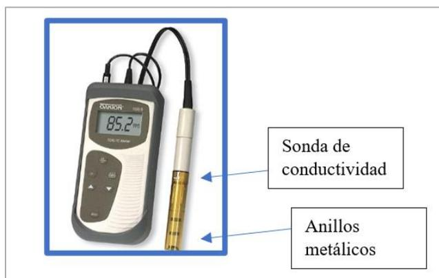
**Figura VIII.3:** Se observa un conductímetro portátil con una sonda o célula de conductividad que incluye los dos electrodos separados por la distancia de 1 cm (anillos metálicos que están por debajo del capuchón amarillo transparente, en el extremo inferior de la sonda).
