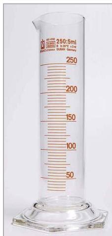
**Figura I.13:** Probeta graduada de vidrio de 250 mL. Esta probeta puede utilizarse para medir diferentes volúmenes hasta un máximo de 250 mL. El diámetro del recipiente es mucho mayor si se compara al de una pipeta o bureta, por lo que la medida de volumen es menos exacta.
