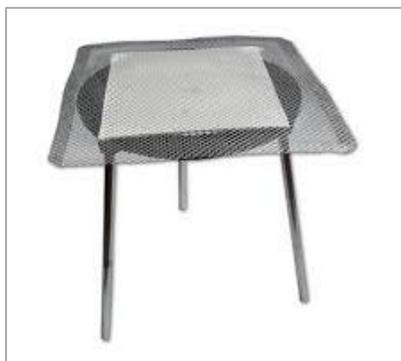
**Figura I.27:** Trípode y malla metálica utilizadas para operaciones de calentamiento con mechero.
