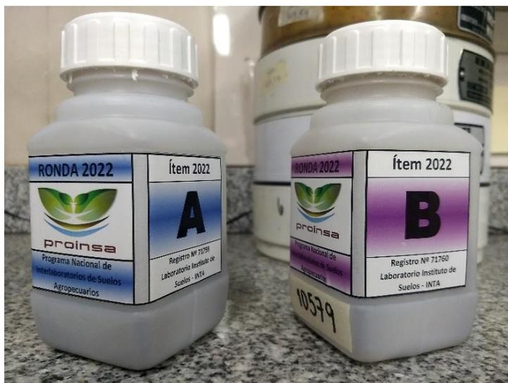
**Figura I.34-** ítem de ensayo A y B para laboratorios agropecuarios. Los ensayos cuyos resultados se evalúan son Carbono Orgánico, Nitrógeno Total, pH, Fósforo disponible y Cationes intercambiables.
