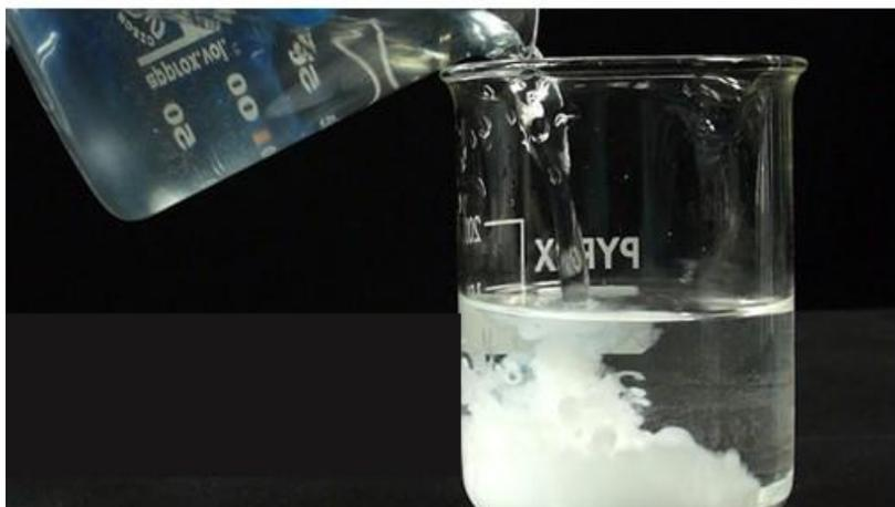
**Figura V.1:** Reacción de precipitación. Al agregar solución de cloruro de calcio a una solución de carbonato de calcio, se observa la formación de un precipitado blanco carbonato de calcio.
