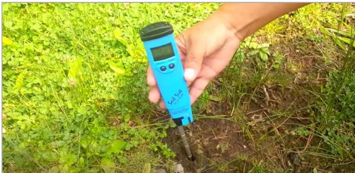
**Figura I.1:** Medición a campo de la salinidad del suelo.
