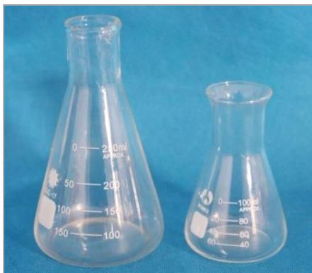
**Figura I.24:** Erlenmeyer. La fotografía muestra dos Erlenmeyer, de 250 mL y 100 mL, respectivamente.
