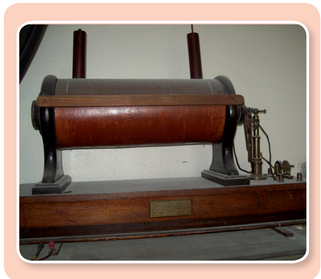
Figura 3: bobina de Ruhmkorff. Se utiliza para conseguir una diferencia de potencial elevada, necesaria para utilizar en tubos de descargas de gases, con la particularidad de que la tensión que se aplica en el circuito primario es continua en lugar de alterna. La generación de las corrientes inducidas en el circuito secundario se consigue con un interruptor que convierte la corriente continua del primario en una corriente variable.
