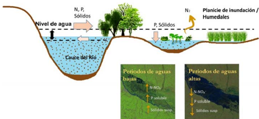
Figura 5. Esquema de la interacción del agua del río Paraná con los humedales de la llanura de inundación en el delta. Procesos de retención y eliminación de nutrientes y sólidos.
