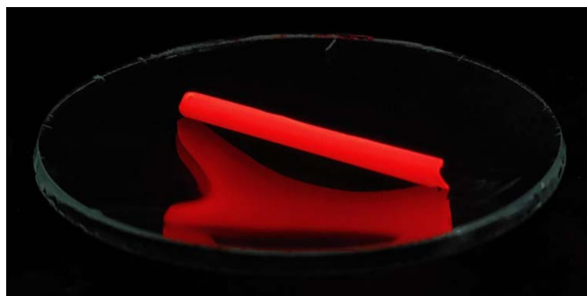
Figura 4. Nanocompuestos YVO_4:Eu^{3+}/PMMA irradiados con luz UV (Con forma de cilindro, apoyado sobre un vidrio de reloj e irradiado desde arriba).
