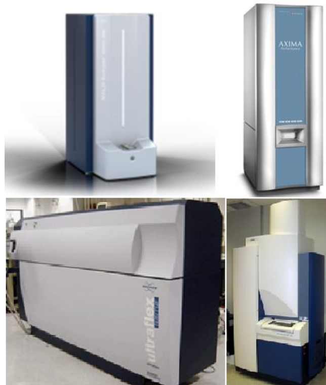
Figura 9. Equipos MALDI-MS: (arriba)(izquierda) MALDI-TOF Biotyper (montaje del analizador TOF vertical, altura aprox. 1 m); (derecha) MALDI-TQ/TOF (montaje del analizador TOF vertical, altura aprox. 2 m); (abajo)(izquierda) MALDI-TOF/TOF (montaje del analizador TOF/TOF horizontal, ancho a-prox. 2,30 m); (derecha) MALDI-TOF/TOF (montaje del analizador TOF /TOF vertical, altura aprox. 2,50 m). Tomadas de los catálogos correspondientes.
