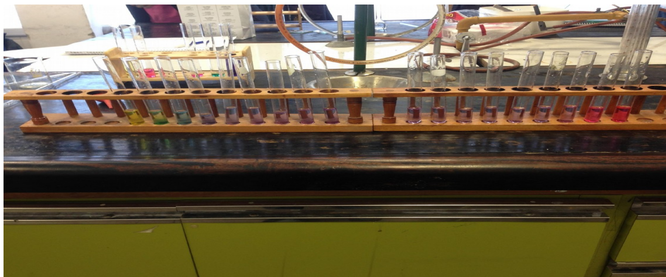
Escala colorimétrica de diluciones partiendo de un ácido y una base realizada por los estudiantes del ISP Joaquín V. González (2014)
