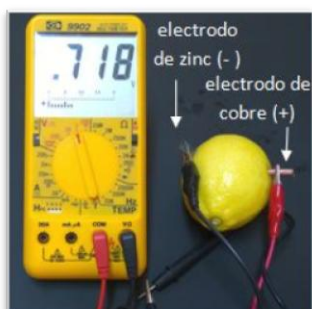
Figura 3: Voltaje que genera el par Cu-Zn. Figura 4: Un Led encendido con “la pila de limón”.
