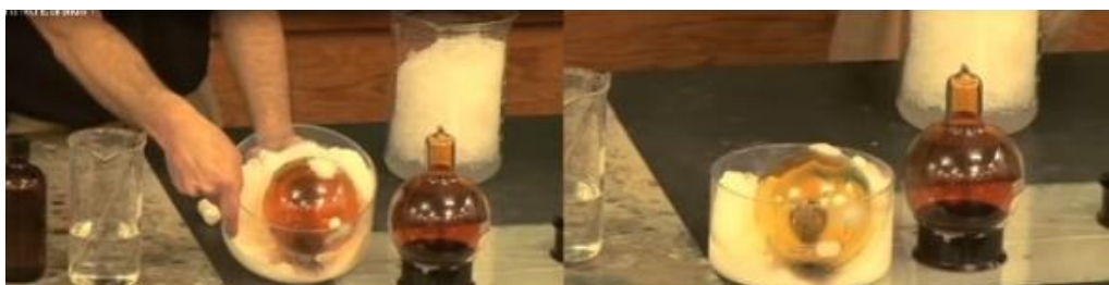
Figura 3: Imágenes del balón que contiene una mezcla de dióxido de nitrógeno y tetróxido de dinitrógeno a distintas temperaturas
