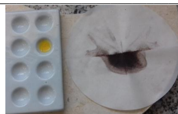
Figura 2. Ensayos de identificación del Pb_3O_4 . A la izquierda se observa la formación del PbI_2 amarillo. A la derecha, PbO_2 sólido, resultado de la reacción con HNO_3 .
