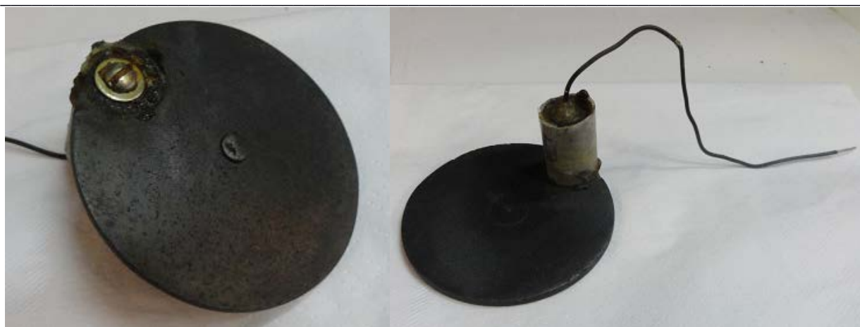
Figura 2. Electrodo de grafito conectado al cable y sellado con epoxy. El electrodo es de 7,5 cm de diámetro.
