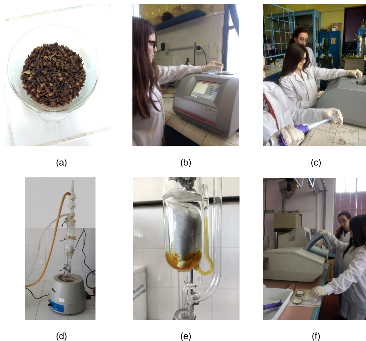
Figura 1. (a) Clavo de olor, (b-c) Extracción asistida por microondas, (d-e) Equipo Soxhlet, (f) Ensayo IR.
