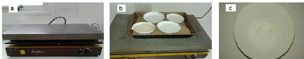
Figura N°2. a) Plancha calefactora. b) Muestras de agua sobre plancha calefactora, c) Cápsula con sales luego de evaporación.
